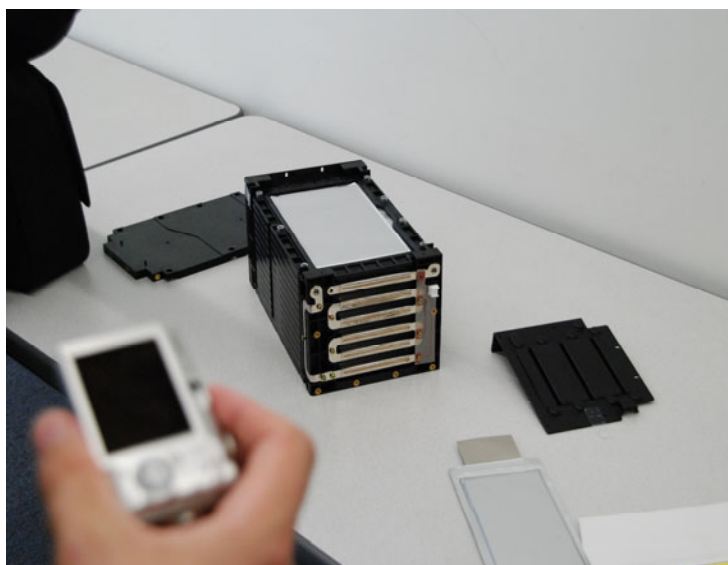
Kompakt Litium-jon batteri utvecklat i samarbete mellan TEPCO och NEC för användning i små tjänstebilar. Foto: Sten Bergman
